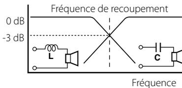
**Self (L) :** Elle laisse passer les fréquences graves mais bloque les fréquences aiguës (filtre passe-bas).
